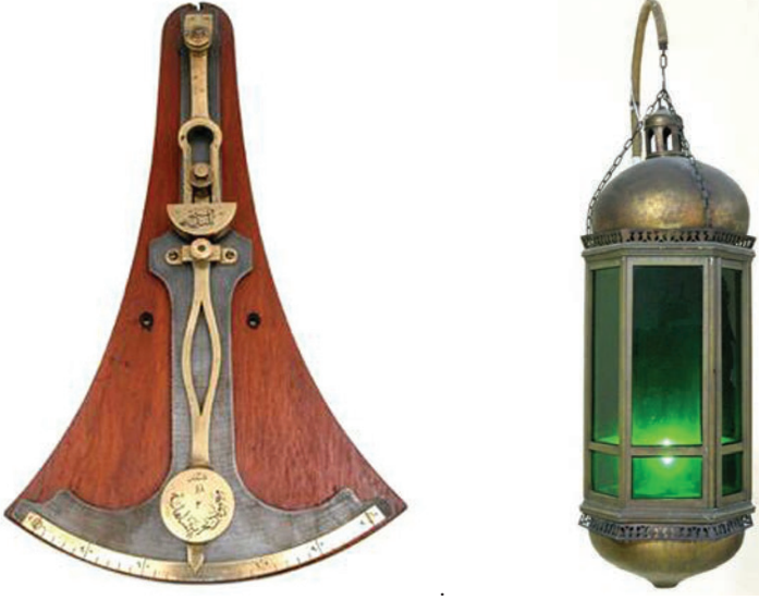
Resim: 43-44 Yalpa Müşiri. Geminin Yalpa Açısını Gösteren Alettir. Feth-i Büleml Korveti- ne Aittir. 1892 Yılında Yapılmıştır. Beşiktaş Deniz Müzesi.
