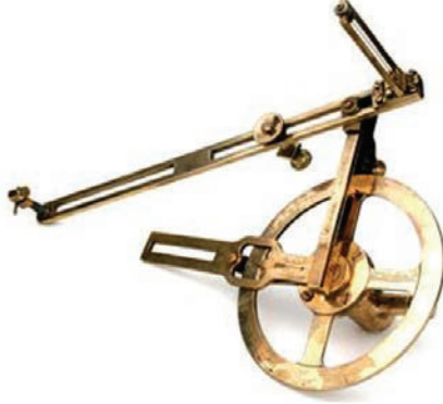
Resim: 39 Torpido Dayrektörü. Torpidoları geminin hedef, rota ve süratine göre ayarlamakta kullanılan Bir Nişan Aletidir. Beşiktaş Deniz Müzesi.
