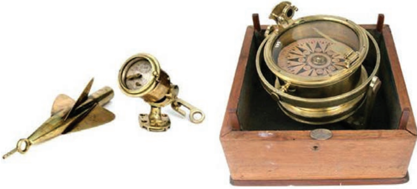
Resim: 40 Uskurlu Parakete. SüratMesa-fesi Ölçen Alettir. 1901 Yılında Tersane-i Amire'de Yapılmıştır. Beşiktaş Deniz Müzesi.
